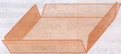
сгибание стенок коробки
