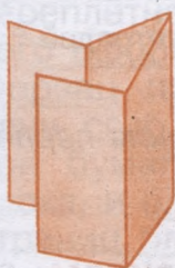
фальцовка параллельная в два сгиба
