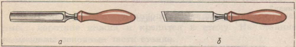
Рис. 176. Режущие инструменты: а — полукруглая стамеска; б — косяк.
