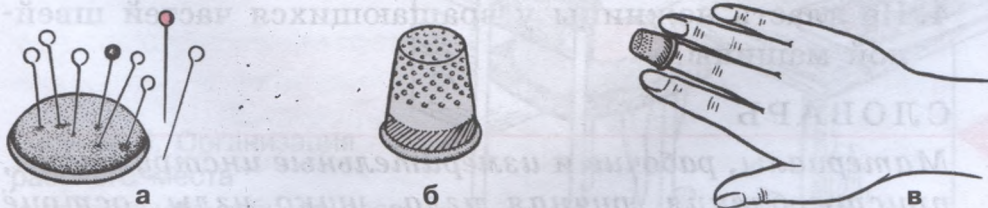
Рисунок 5. Приспособления для швейных работ: а — булавки; б — напёрсток; в — применение напёрстка
