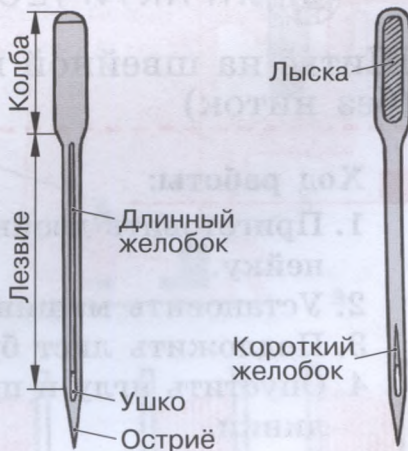
Рисунок 49. Устройство машинной иглы
