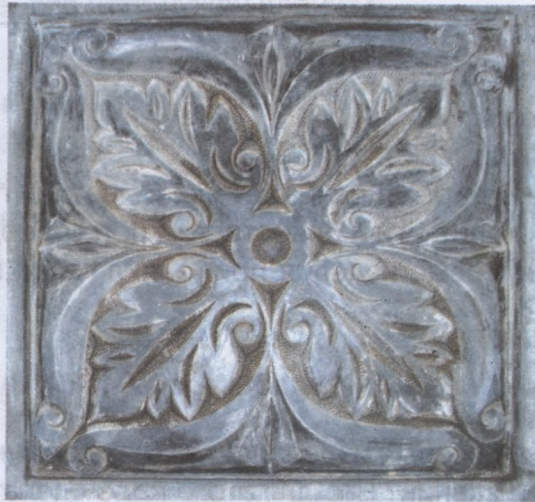
Рис. 33. Форма для отливок из формопласта
