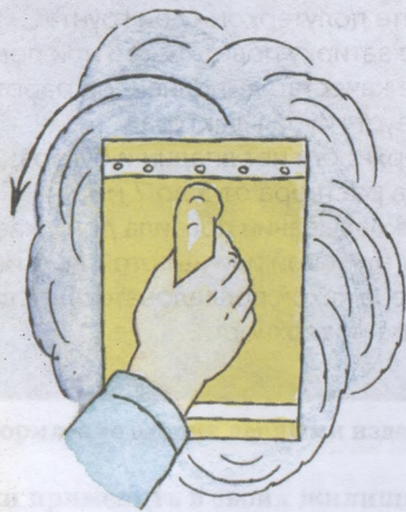
Рис. 28. Затирка штукатурки вкруговую
