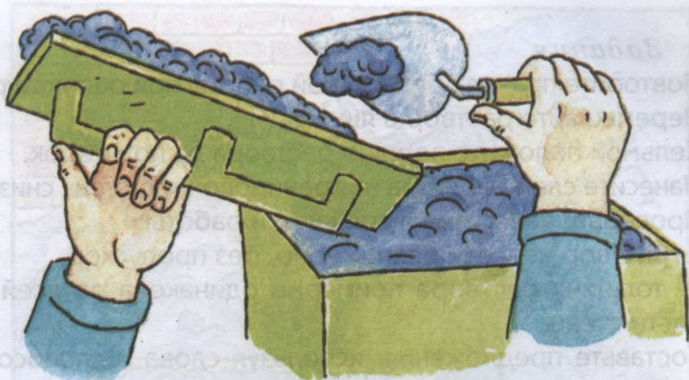
Рис. 25. Накладывание раствора на полутерок
