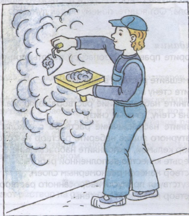
Рис. 24. Набрасывание раствора с сокола
