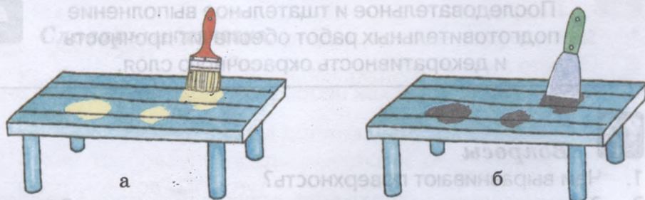
Рис. 8. Грунтование (а) и частичное шпатлевание (б) поверхности
