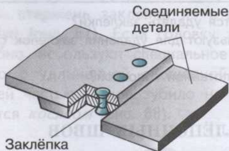
Рис. 70. Однорядный заклёпочный шов внахлёстку
