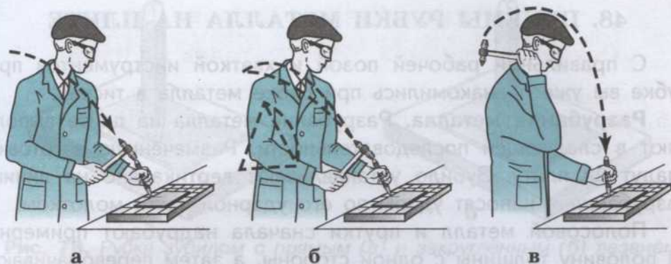
Рис. 76. Виды удара молотком при рубке: а — кистевой; б — локтевой; в — плечевой
