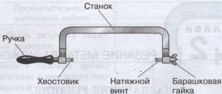
Рис. 19. Цельный ножовочный станок
