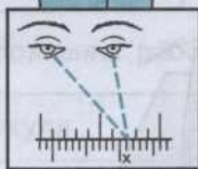
Рис. 102. Считывание показаний штангенциркуля: а — правильно; б — неправильно
