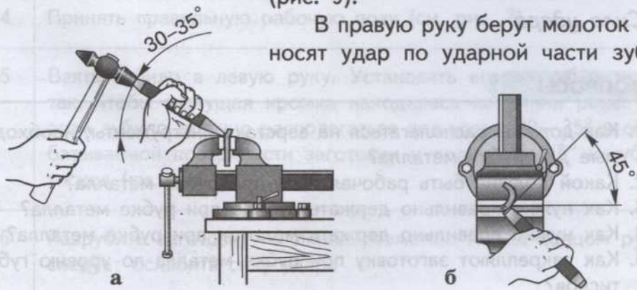
Рис. 9. Установка зубила в рабочее положение:
