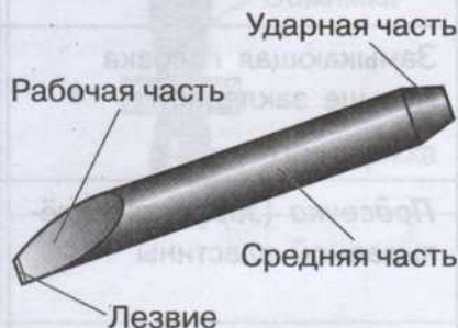
Рис. 68. Зубило для удаления головок заклёпок (косяк)
