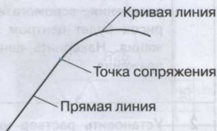
Рис. 85. Сопряжение прямой линии с кривой
