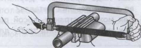
Рис. 26. Отрезание части трубы:
