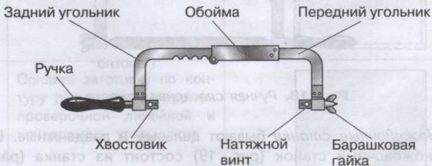
Рис. 20. Раздвижной ножовочный станок
