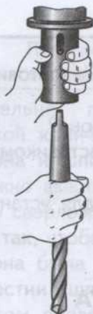
Рис. 32. Установка сверла с коническим хвостовиком в шпинделе станка
