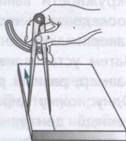
Рис. 82. Нанесение циркулем риски, параллельной базовой кромке
