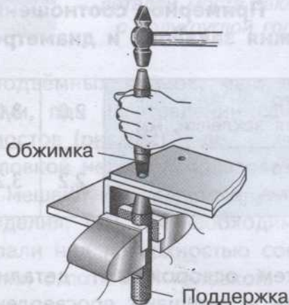
Рис. 66. Окончательное оформление замыкающей головки с помощью обжимки
