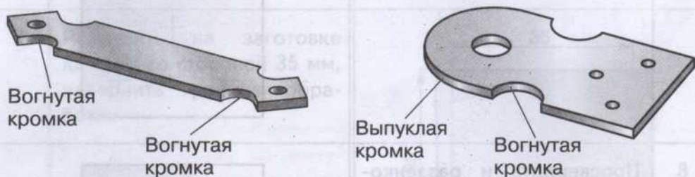
Рис. 39. Детали с криволинейными кромками
