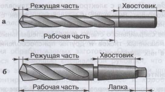
Рис. 29. Спиральные свёрла с цилиндрическим (а) и коническим (б) хвостовиками и их основные части
