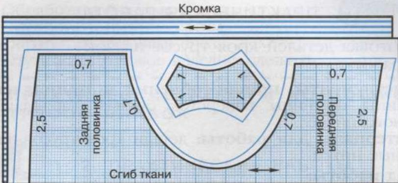
Рис. 62. Раскладка деталей выкройки трусов-плавок на ткани
