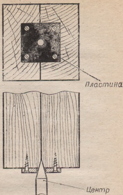
Рис. 127. Опорная пластина для фиксации заготовки.
