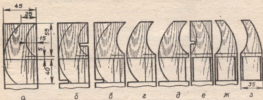
Рис. 75. Рожок для рубанка: а — з — последовательность изготовления.
