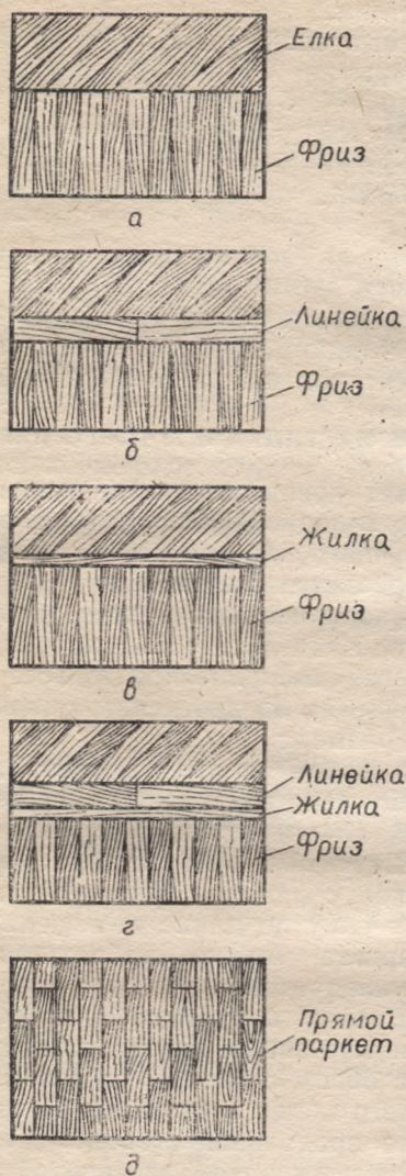
Рис. 216. Способы укладки штучного паркета:
