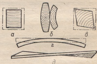
Рис. 65. Виды коробления: а и в — изменение формы поперечного сечения брусков с различным расположением слоев на торце; б — то же, досок (сердцевинной и боковой); г — продольная покоробленность; д — крыловатость.
