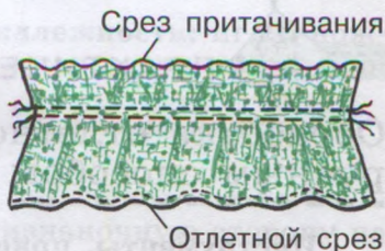
Рис. 18. Названия срезов детали оборки
