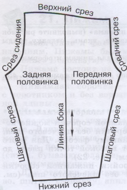
Рис. 33. Названия детали и срезов выкройки пижамных брюк
