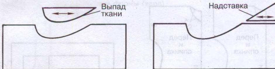
Рис. 28. Использование выпадов ткани для надставок
