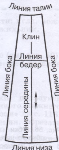
Рис. 57. Названия детали и линий чертежа клина юбки
