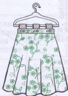
Рис. 50. Подвешивание полуфабриката клешевой юбки для оттяжки нижнего среза
