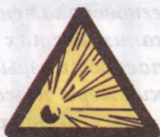
Осторожно! Опасность взрыва
