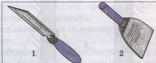
Рис. 21. Инструменты для расшивки трещин: 1 – нож, 2 – шпатель
