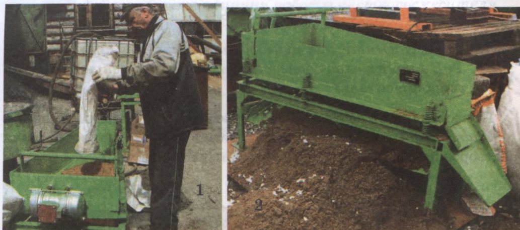
Рис. 4. Вибросито: 1 – сито, 2 – разгрузочный лоток
