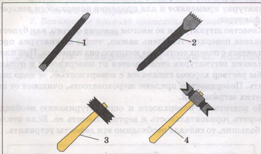
Рис. 13. Инструменты для насечки каменных поверхностей: 1 – зубило, 2 – зубчатка, 3 – бучарда, 4 – насечной молоток
